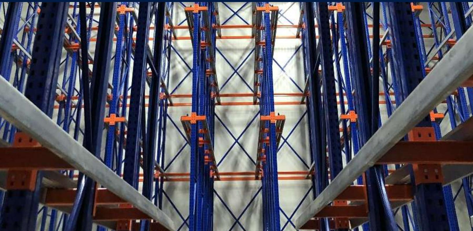
Racks Industriales especiales para almacenaje de alta densidad, proporciona la máxima utilización del espacio empleando hasta un 85% de la superficie disponible, consiste en eliminar pasillos ya que está diseñado para que el montacargas ingrese al interior del rack colocando la carga en carriles de apoyo para las tarimas.
