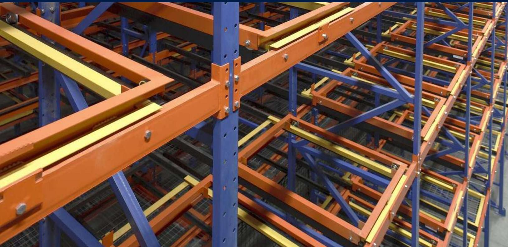
Sistema gravitacional que puede almacenar de dos a seis tarimas de fondo lo cual facilita la selectividad en la operación de carga y descarga.
