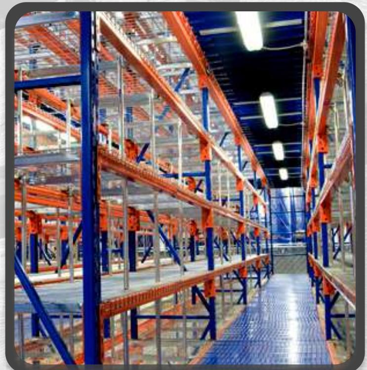
El sistema entrepiso es usado en racks para cargas manuales. Generalmente se diseña en combinación con otro sistema de almacenaje como puede ser estantería.
