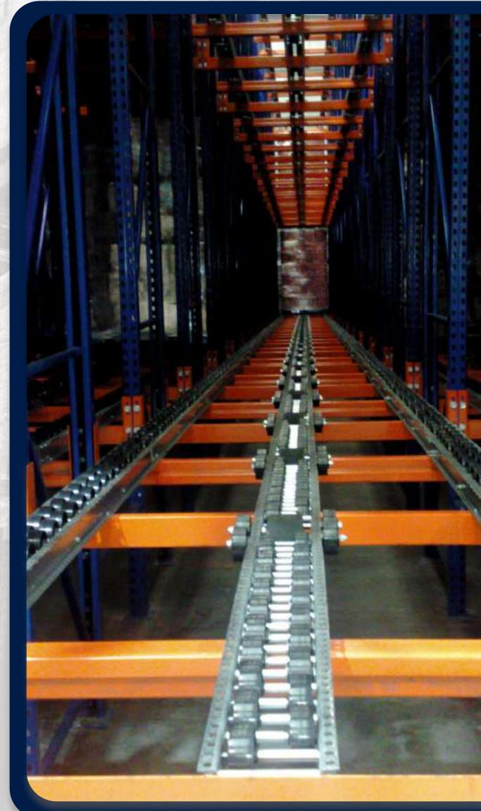
Las tarimas se introducen al sistema por el extremo alto, para poder ser extraídas por el extremo contrario, por lo que genera una rotación de primeras entradas, primeras salidas, (PEPS).
